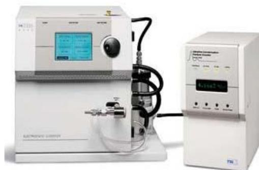
Abbildung 6.7: Verwendetes SMPS TSI3080 [31]
