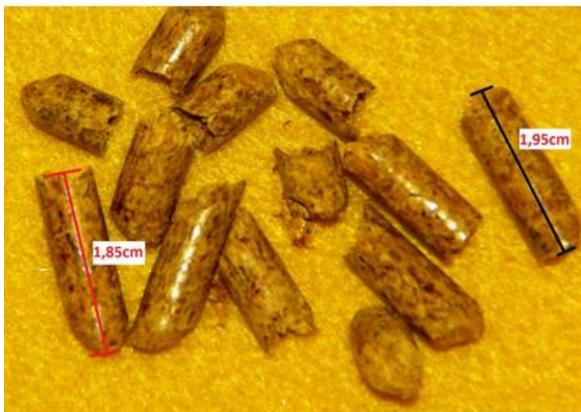
Abbildung 6.12: stabförmige Holzpellets
