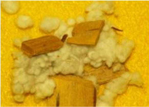
**Abbildung 6.16: Viskosefaserflocken-Holzspänemischung**
