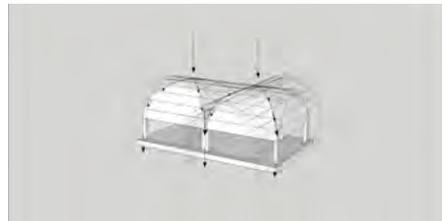
Abb. 33 Schema Lastabtragung Kreuzgewölbe
