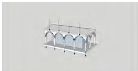
**Abb. 30 Schema Lastabtragung Rundbogen**
