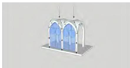
Abb. 34 Schema Lastabtragung Kreuzrippengewölbe
