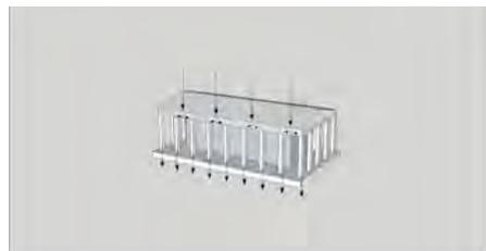
**Abb. 29 Schema Lastabtragung Tempel**
