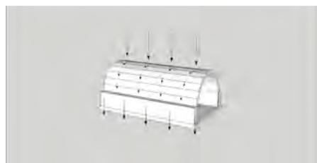
**Abb. 31 Schema Lastabtragung Tonnengewölbe**
