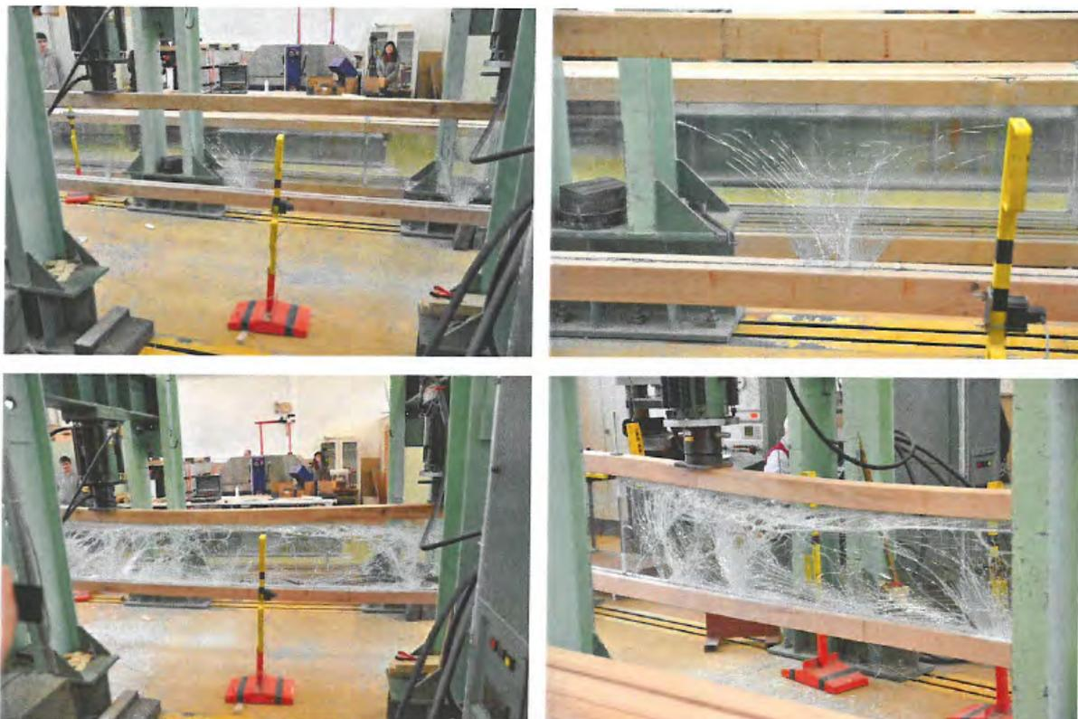
**Abb. 83 Versuchsergebnisse Biegeversuche bis zum Totalversagen " Wiener - Kastenträger - Weiterentwicklung"; Quelle: Institut für Tragwerksplanung und Ingenieurholzbau - TU-Wien**
