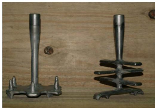
Abbildung 4-7: Mischwerkzeuge für EIRICH R02, Stiftenwirbler (links) und Sternwirbler (rechts) [36]
