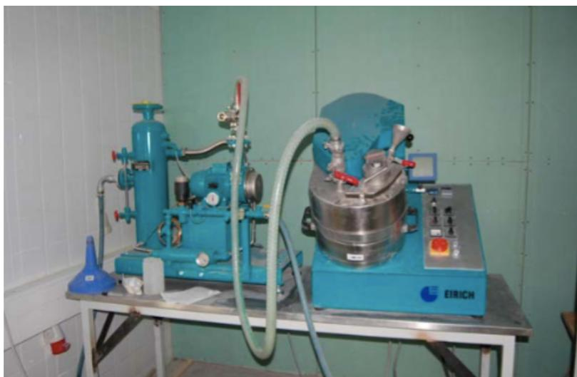
Abbildung 4-5: Intensivmischer EIRICH R02 (rechts) mit Vakuumpumpe Fa. Sterling (links) [36]
