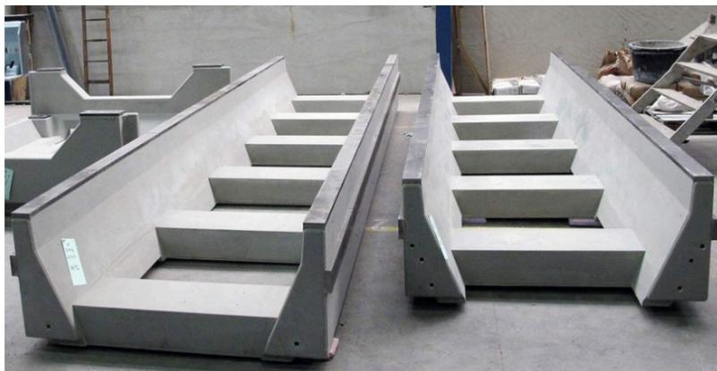
Abbildung 2-13: Maschinenbetten aus UHPC [55]
