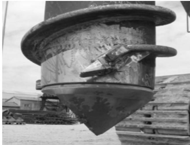
Abbildung 2-14: Bohrspitze aus UHPC [36]
