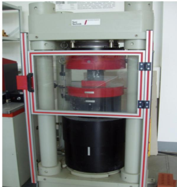
Abbildung 4-20: Druckfestigkeitsprüfung mittels Toni Technik Modelle 2040 [36]
