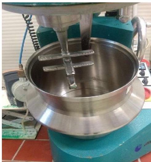
Abbildung 4-1: Intensivmischer EIRICH R02 mit Sternwirbler
