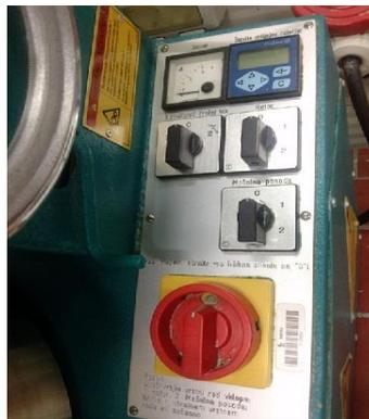
Abbildung 4-4: Manuelle Bedieneinheit des EIRICH-Mischers
