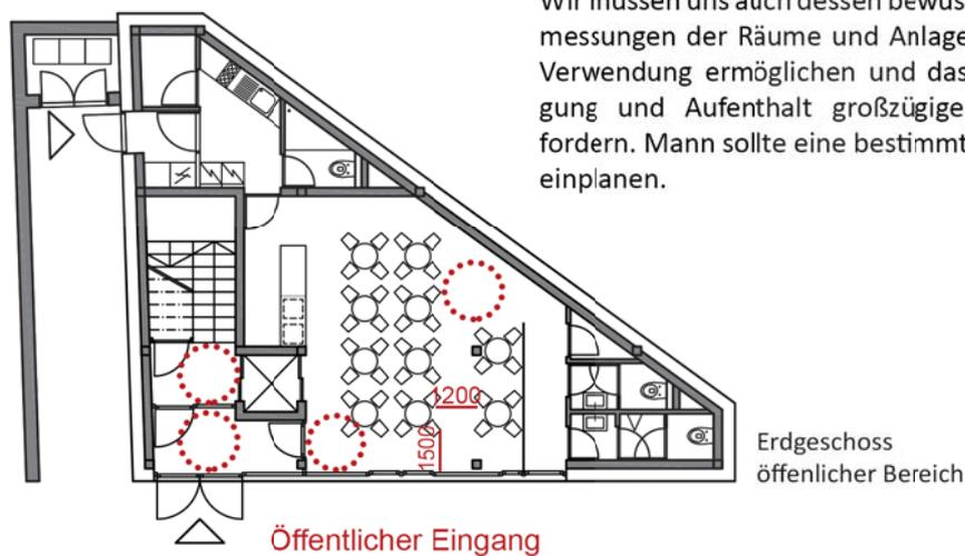
Abb. 76: Darstellung der Lösung eines barrierefreien Entwurfes in kritischen Stellen (1:200).
