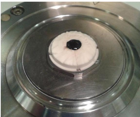
Abbildung 5.13 Eingefüllte Mastix
