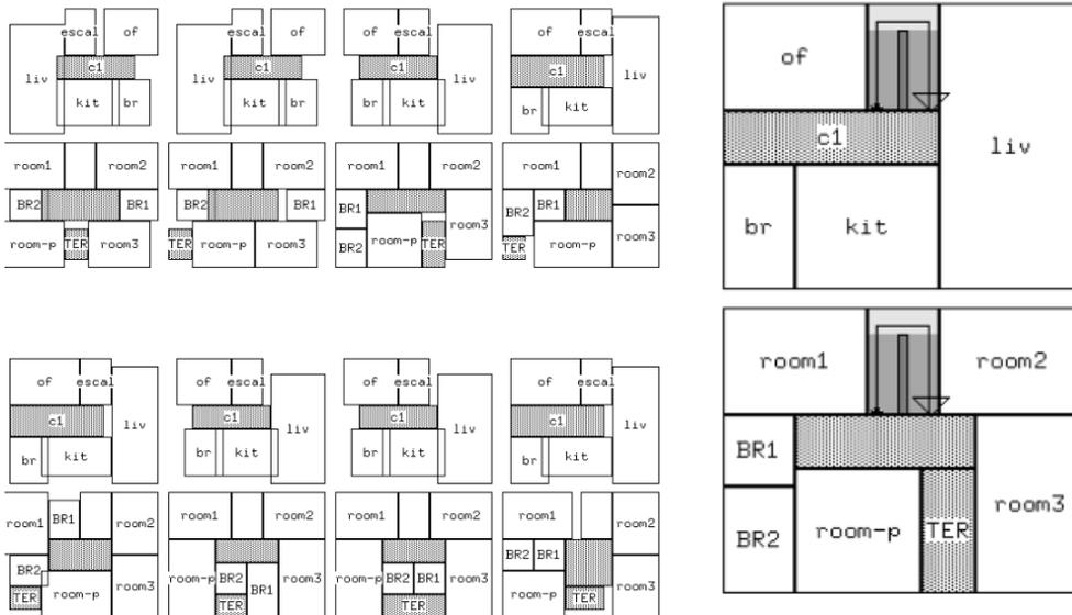
Abbildung 4 - Bandbreite möglicher Topologien für ein zweigeschoßiges Einfamilienhaus (links) und eine geometrisch optimale Lösung der Topologie 3 (rechts)<sup>7</sup>
