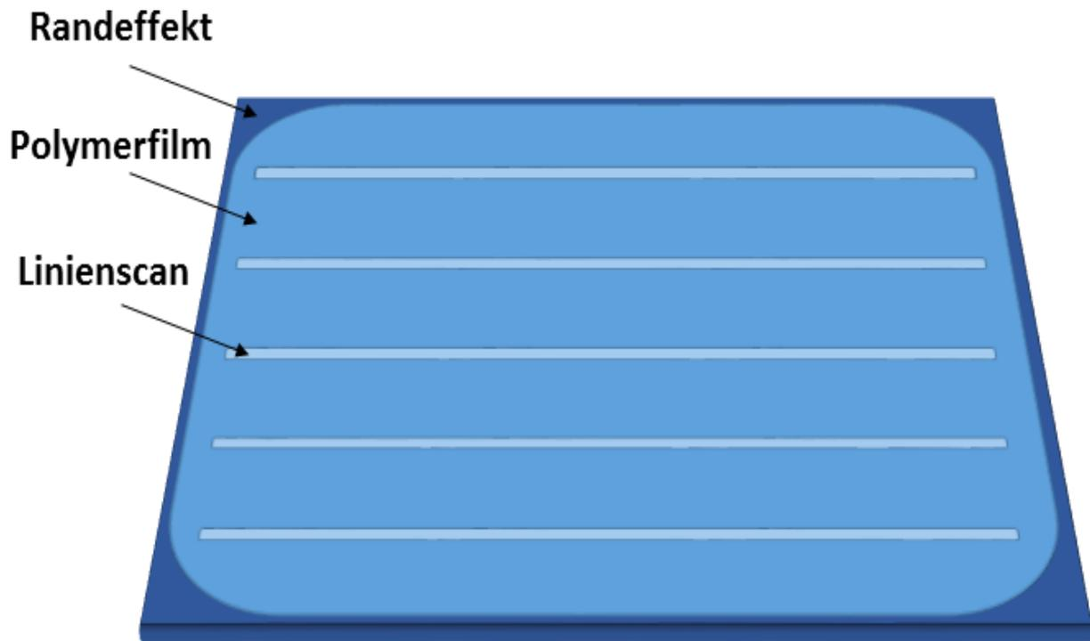
Abbildung 19: Linienscan eines gecoateten Wafers
