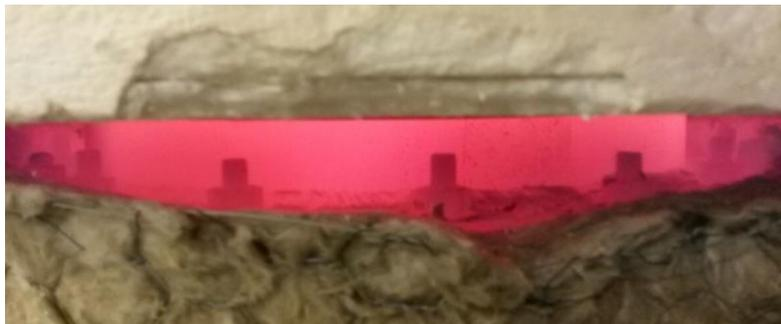
*Abbildung 42 Glühende Flanschverbindung bei 830 °C*
