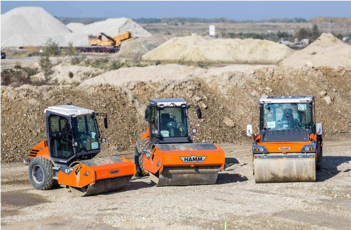
Abbildung 10.2: Die drei Messwalzen der experimentellen Validierungsversuche: *HAMM H7i VIO* [46], *HAMM H13i VIO* [45] und *HAMM HD<sup>+</sup> 140i VO* [47] (v.l.n.r.). ©designstist, A. Reautschnig.
