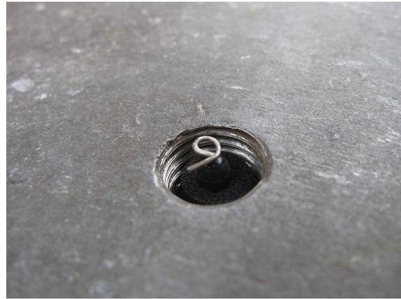
(b) Einschrauben des Potentiometers in den Walzmantel der Oszillationsbandage.
