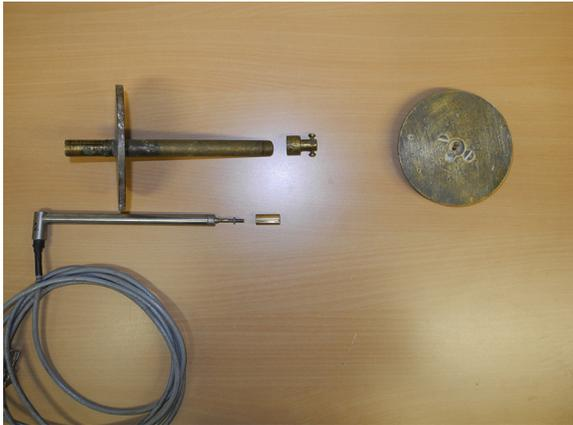
(a) Komponenten des Verformungsmessgerätes.
