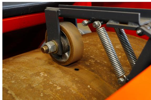
(b) Positionsrad zur Bestimmung der Asymmetrie der Kontaktlänge.
