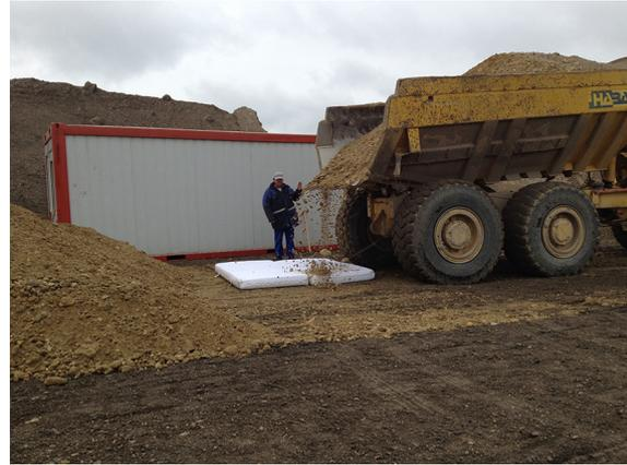
(b) Einbau der künstlichen Schwachstelle in Form von zwei handelsüblichen Federkernmatten unter der Spur 2 des Testfeldes.
