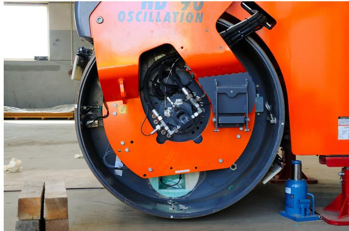
Abbildung 4.7: Einaxiale Beschleunigungssensoren des Typs 8315A der Firma *Kistler* an der Oszillationsbandage.
