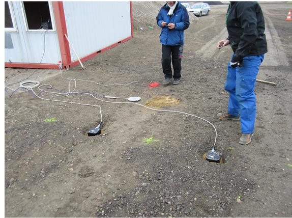
(b) Anordnung der Beschleunigungsaufnehmer unter den Spuren 2 und 3 des Testfeldes.
