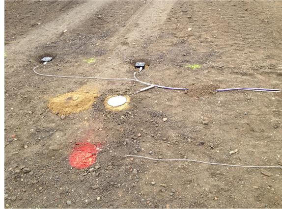
(b) Anordnung der dynamischen Erddruckmessdose und der Beschleunigungsaufnehmer unter den Spuren 2 und 3 des Testfeldes.
