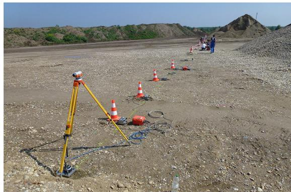
(b) Aufstellung triaxialer Beschleunigungsaufnehmer an der Oberfläche des Unterbauplanums zur Erfassung der Erschütterungswirkung.
