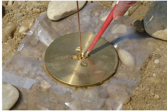
(b) Klemmung des Drahtes an der Messingplatte an der Oberfläche der zu verdichtenden Schicht.
