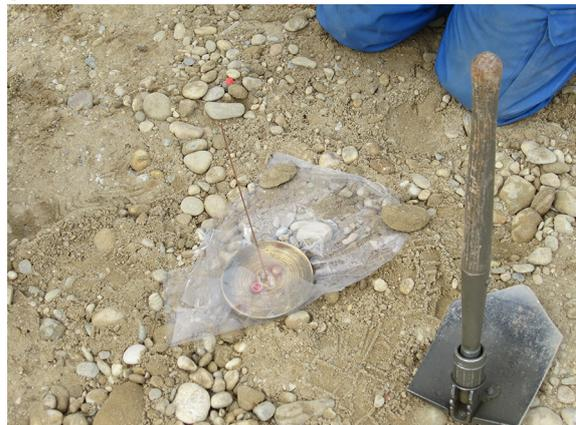
(d) Messingplatte an der Oberfläche der zu verdichtenden Schicht und Klemmung des Drahtes.
