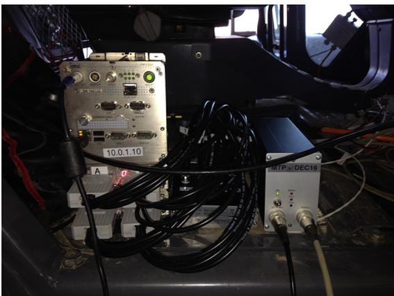
(e) Empfänger zur Umwandlung der digitalisierten Signale in Analogsignale und Speicherung im *imc CRONOSflex* System.
