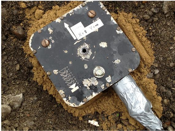
(a) Koordinatensystem und horizontale Ausrichtung eines triaxialen Beschleunigungsaufnehmers.
