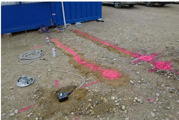
(a) Anordnung des Beschleunigungsaufnehmers unter der Spur 2 des Testfeldes.
