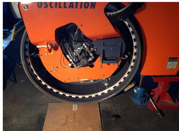
(f) Fertig installiertes Telemetriesystem an der Oszillationsbandage.
