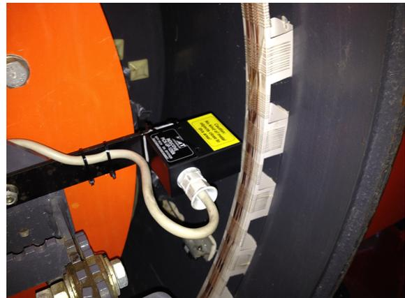
(d) Induktiver Aufnehmer am Rahmen der Walze zur Auslesung der Daten von der Spule.
