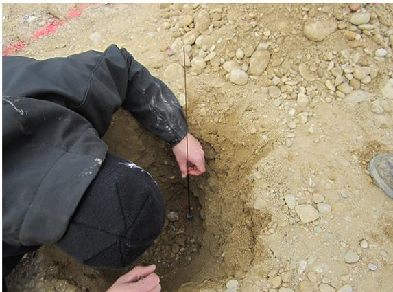
(c) Verlängerung des beweglichen Teils des induktiven Wegaufnehmers durch einen Draht.
