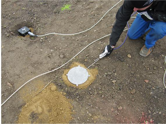
(a) Einbau der dynamischen Erddruckmessdose auf einer Ausgleichsschicht aus Sand.
