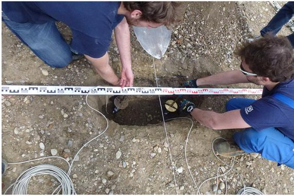
(a) Einbau der feststehenden Teile der Verformungsmessgeräte in den Untergrund.
