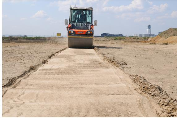
(b) Ausgeprägte Wellenbildung an der Oberfläche der Spuren 6 und 7 bereits nach wenigen Überfahrten.
