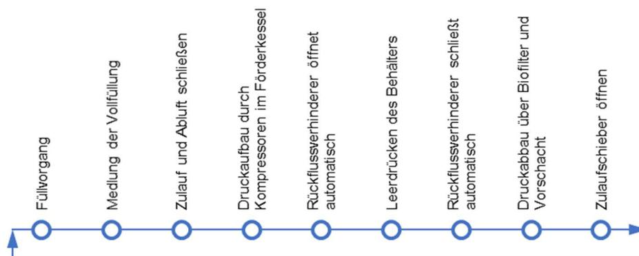
Abbildung 3.19: Beschreibung des Förderzyklus einer pneumatischen Überdruckanlage
