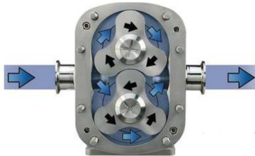
Abbildung 3.14: Prinzipskizze Drehkolbenpumpe [11]
