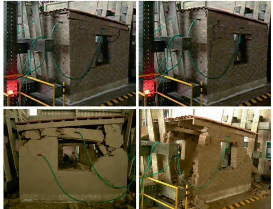
7 - 10 - Entwicklung von Schadensbildern in unterschiedlichen Phasen einer Adobe Konstruktion unter dynamischer Belastung.
