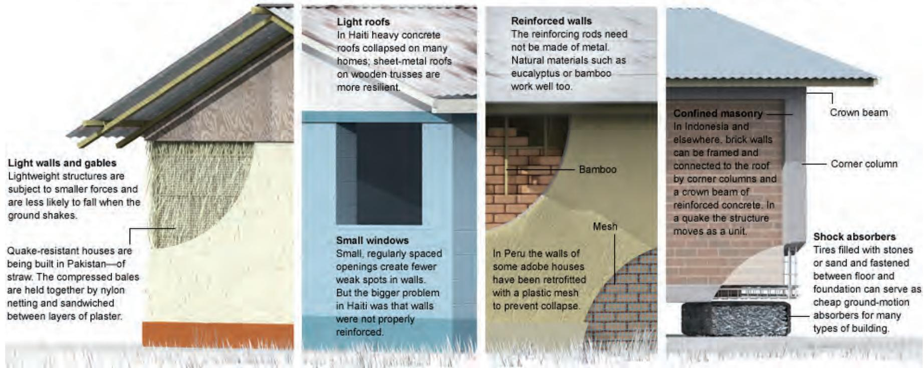
1 - Bautechnische Maßnahmen zur besseren, statischen Stabilisierung von Mauerwerken gegen Erdbebenkräfte
