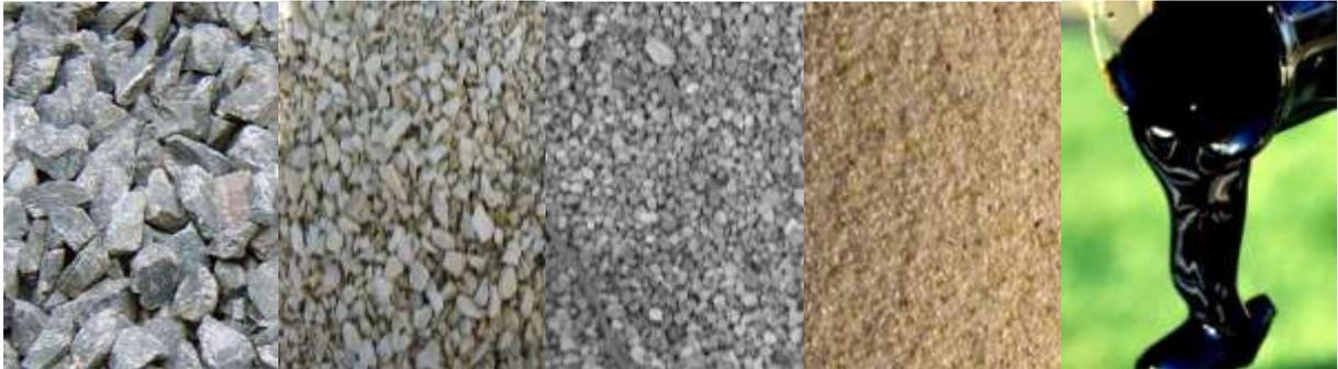
**Abb. 5 Schotter**   **Abb. 6 Split**   **Abb. 7 Kies**   **Abb. 8 Sand**   **Abb. 9 Bitumen**
