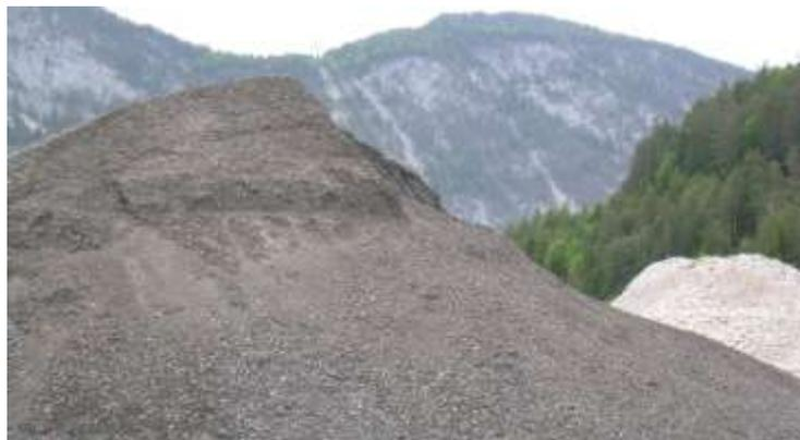
**Abb. 25 Fräsasphalt**
