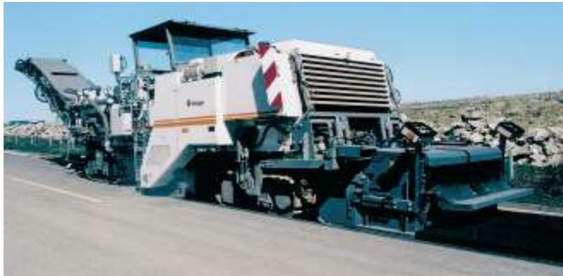
**Abb.19 Kaltrecycler Wirtgen 2200 CR**
