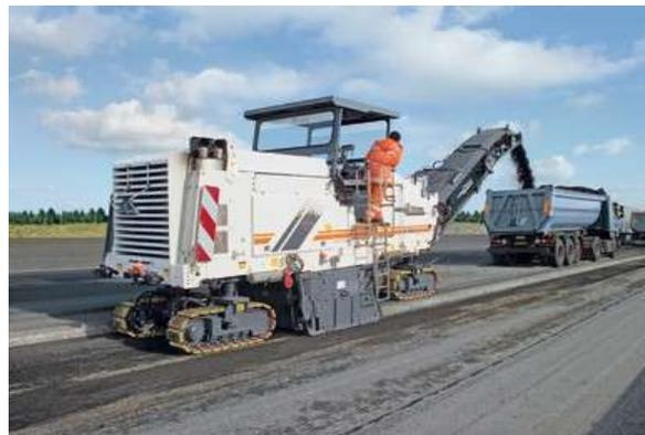
**Abb. 27 Kaltfräse Wirtgen W 1900**
