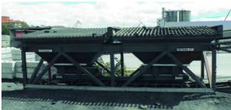
Abb. 58 Getrennte Recycling – Doseure mit geeignetem Siebrost
