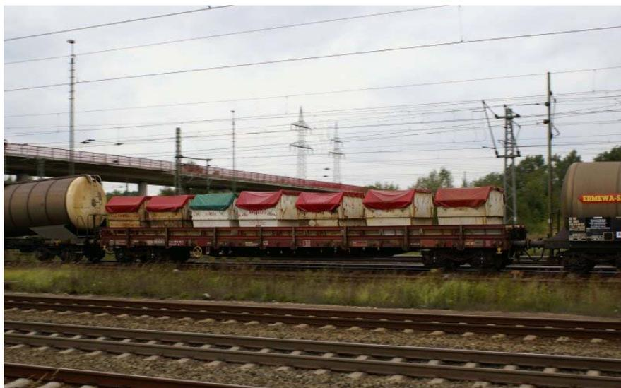
Abb.40: Tragwagen beladen mit Schüttgutcontainer<sup>82</sup>
