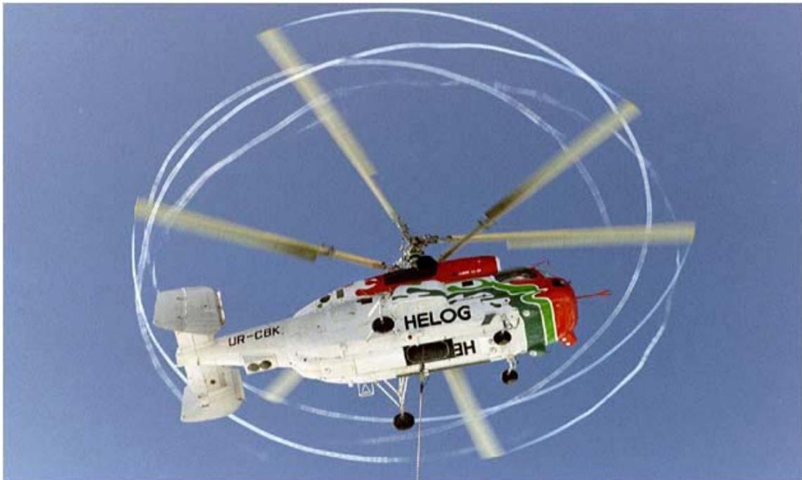
Abb.44: Schwerlasthelikopter: Kamov KA-32T<sup>86</sup>
