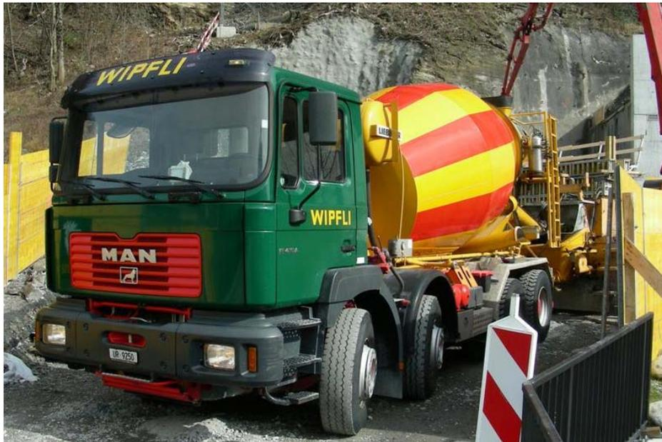
Abb.25: Fahrmischer für Betontransporte<sup>66</sup>
