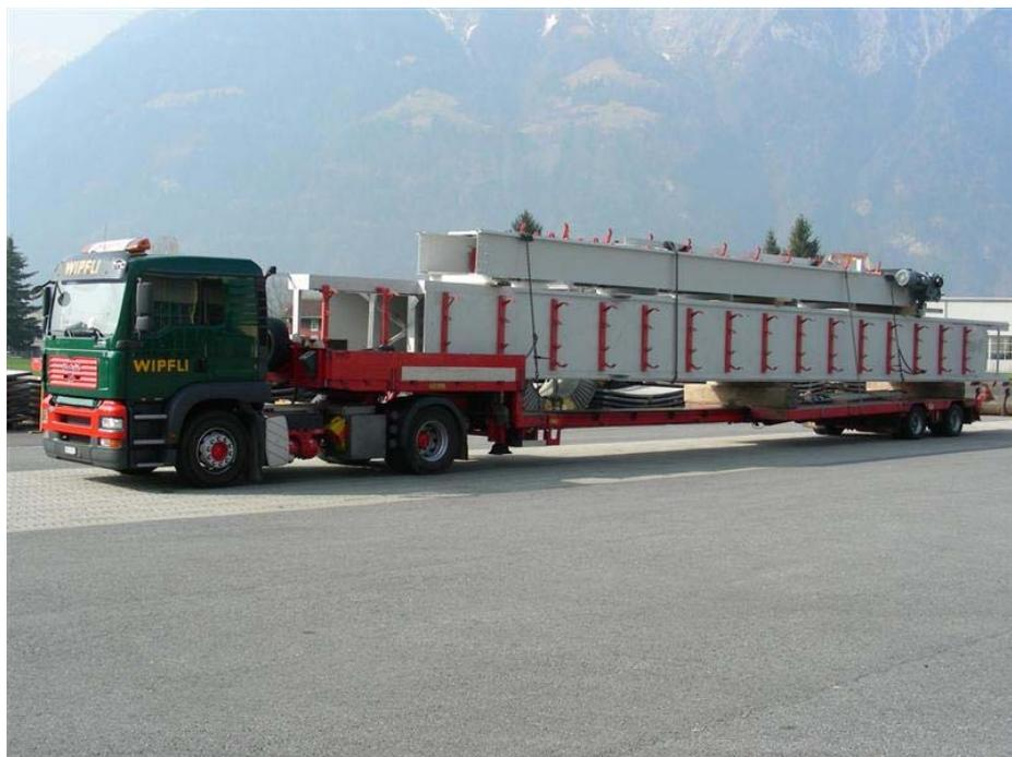
Abb.30: Fahrzeug für Langguttransporte<sup>71</sup>
