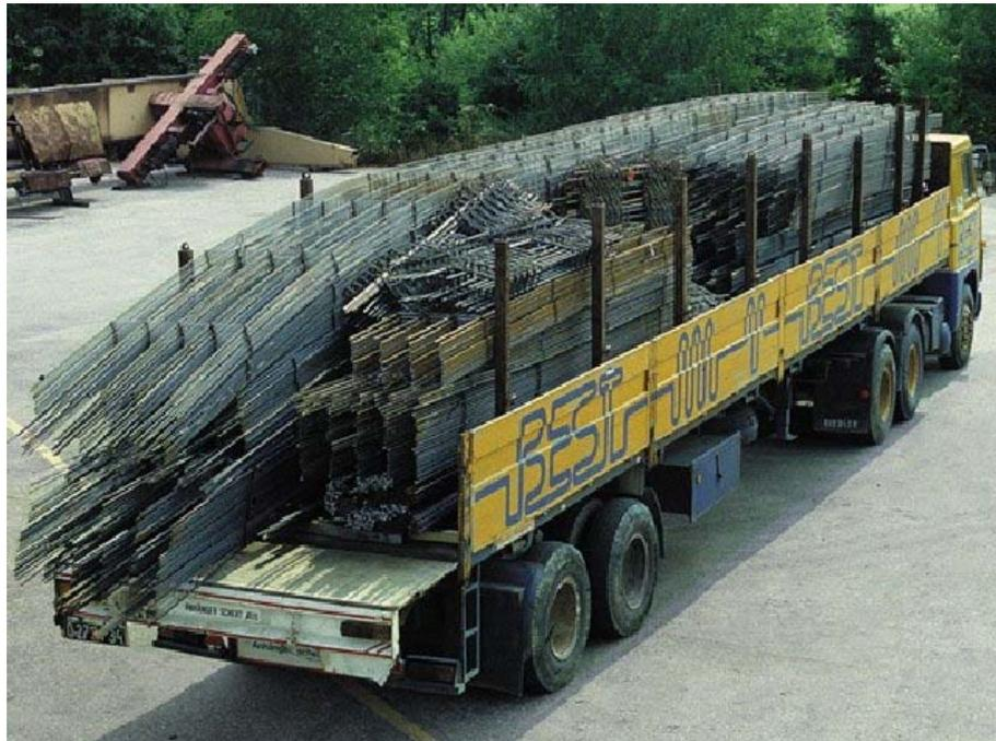
Abb.16: Sattelzug - Plattformaufbau<sup>56</sup>
