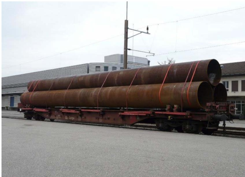
Abb.42: Schientiefladewagen für z.B. Stahlrohr- oder Baumaschinentransporte<sup>84</sup>
