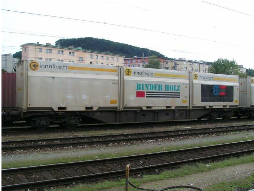
Abb.39: Tragwagen für Container und Wechselbehälter<sup>81</sup>
