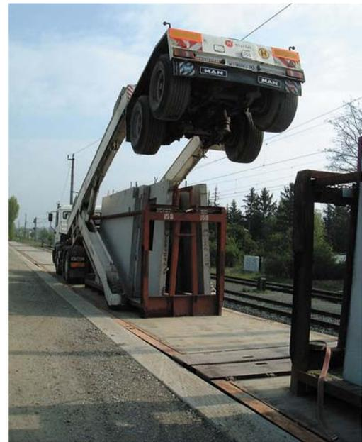
Abb.65: Spezialfahrzeug für Fertigteilumschlag<sup>120</sup>
