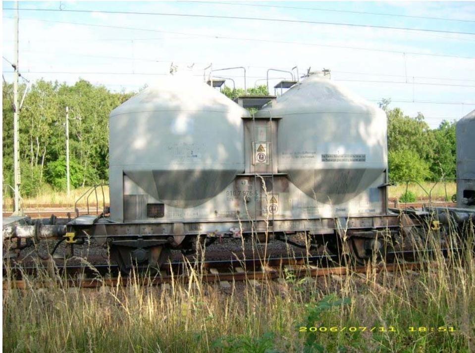
Abb.38: Behälterwagen für Zementtransporte<sup>80</sup>
