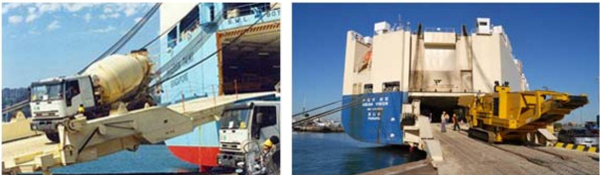
Abb.52: Ro/Ro-Schiff – Be- und Entladung über Rampen<sup>101</sup>
