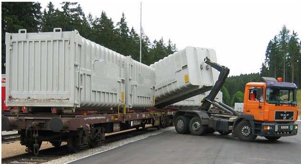
Abb.59: Umschlagen eines ACTS-Containers vom LKW auf einen Güterwagen<sup>112</sup>
