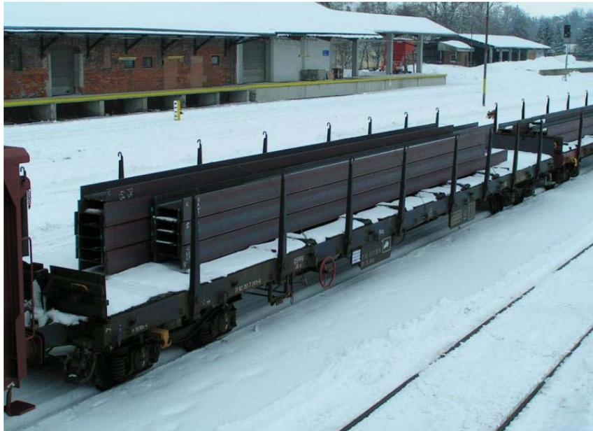
Abb.41: Drehgestellflachwagen für z.B. Stahlträger- oder Fertigteiltransporte<sup>83</sup>
