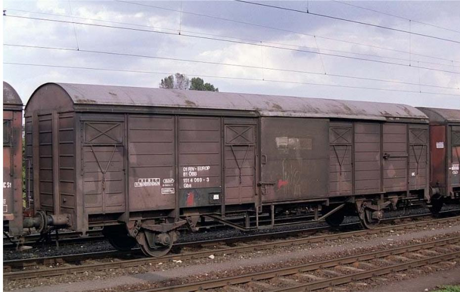
Abb.34: Gedeckte Güterwagen für witterungsempfindliche Stückgüter<sup>76</sup>
