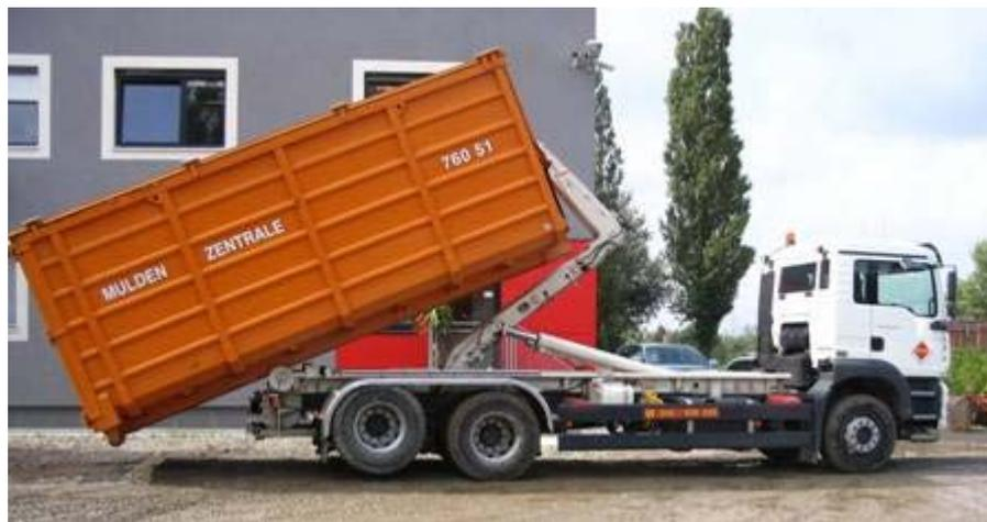
Abb.31: 3-Achs Hakenabrollcontainerkipper<sup>72</sup>
