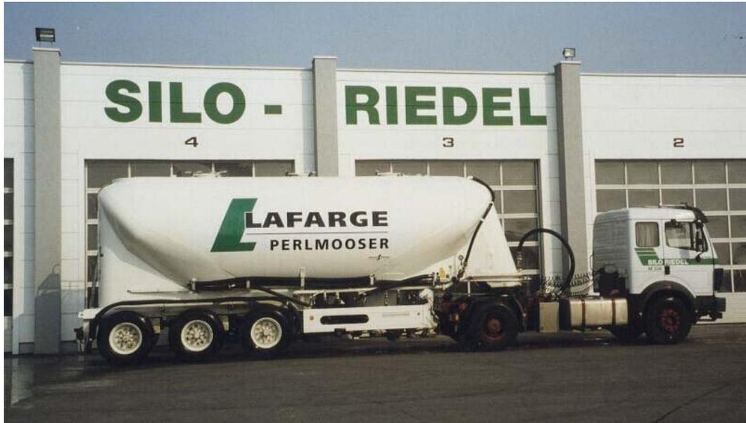
Abb.24: Kippsilofahrzeug für Zementtransport<sup>65</sup>
