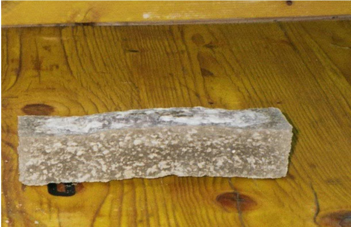
Abbildung 4.20 Schimmelbildung an einer Probe mit 17 % Kaseinzusatz
