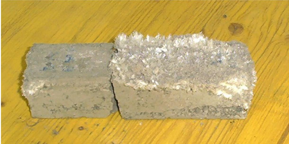
Abbildung 4.49 Ein gebrochener Probekörper der 10%H + 0,1% Am - Serie mit Ausblühungen
