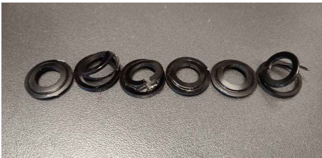
Abbildung 17: Scherprüfkörper nach der Prüfung
