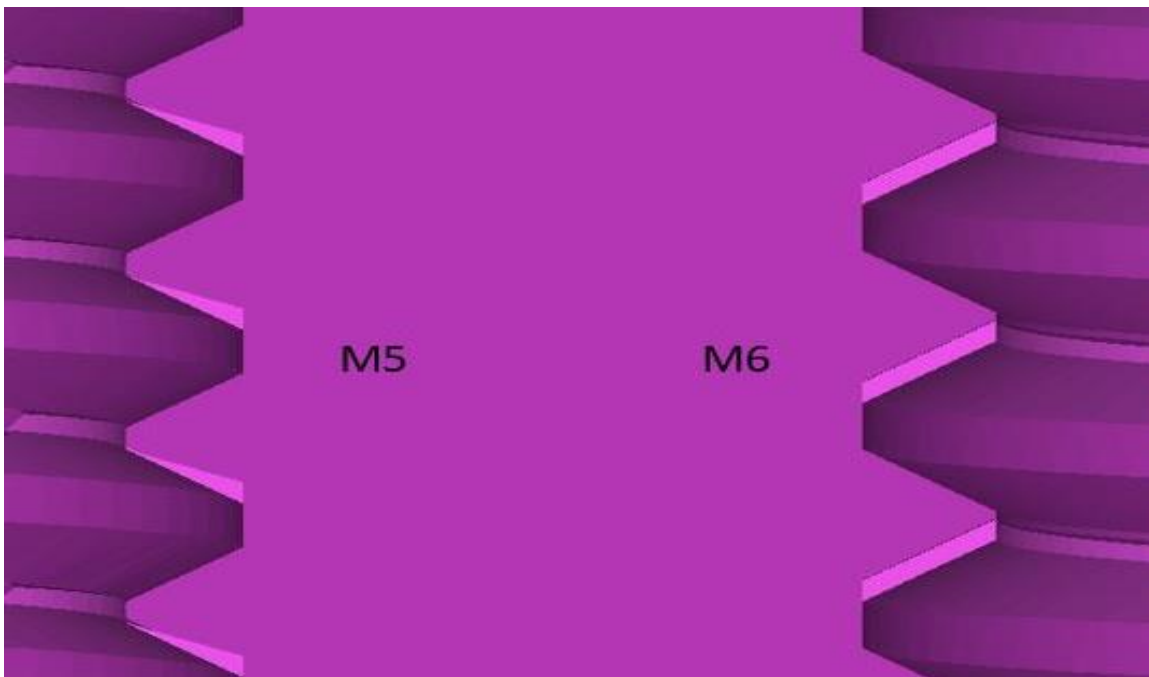
Abbildung 25: Z-Kompensation des Probenkörpers (Abbildung 26). Details Ansicht von M5 und M6 im Querschnitt [19]
