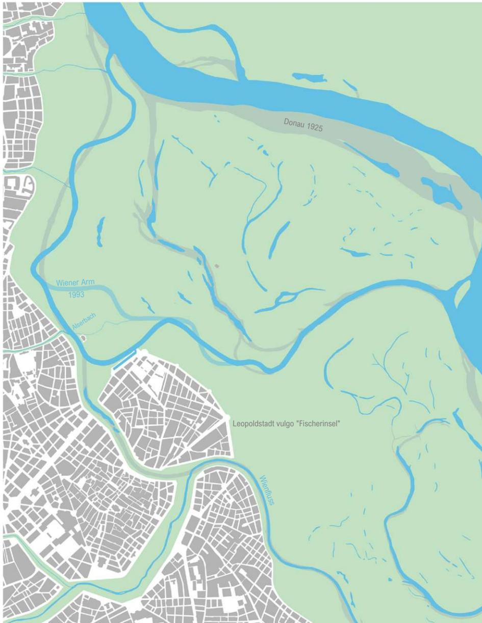
Abb. 4.7 Der obere Teil der Wiener Donau im heutigen Zustand in einer Überlagerung mit jenem von 1925 sowie - für den Wiener Arm - von 1993. Damals folgten nämlich auf die 1964 beschlossene und durchgeführte Deregulierung des Donaukanals wiederum regulierende Maßnahmen, die durchaus umstritten waren, aber den Wiener Arm auf einem kurzen Abschnitt wieder an die Stadt anbanden.
