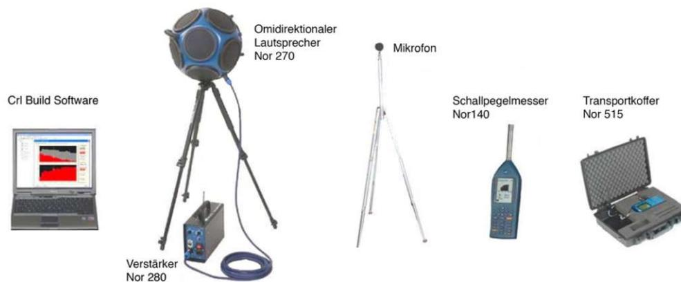
Abbildung 39 Messungsequipment (basierend auf den NORSONIC Katalog)
