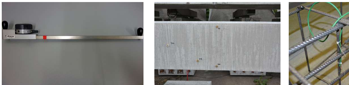
Abb. A.8: Messtechnik: Setzdehnungsmesser (links); Aufgeklebte Messpunkte für Messungen mittels Setzdehnungsmesser (mittig); Thermoelement vor der Betonage (rechts)
