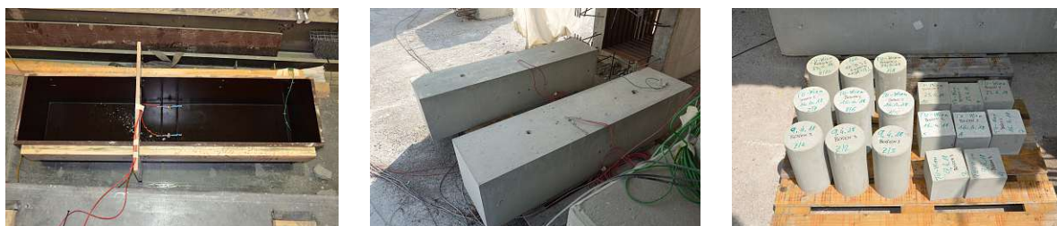
Abb. A.10: Probekörper für die Bestimmung von Materialkennwerten: Schalung und fertiggestellte Vergleichskörper zur Ermittlung des Schwindmaßes und des Temperaturexpansionskoeffizienten (links und mittig); Probezylinder und Würfel zur Bestimmung der Druck- und Spaltzugfestigkeit sowie des Elastizitätsmoduls (rechts)
