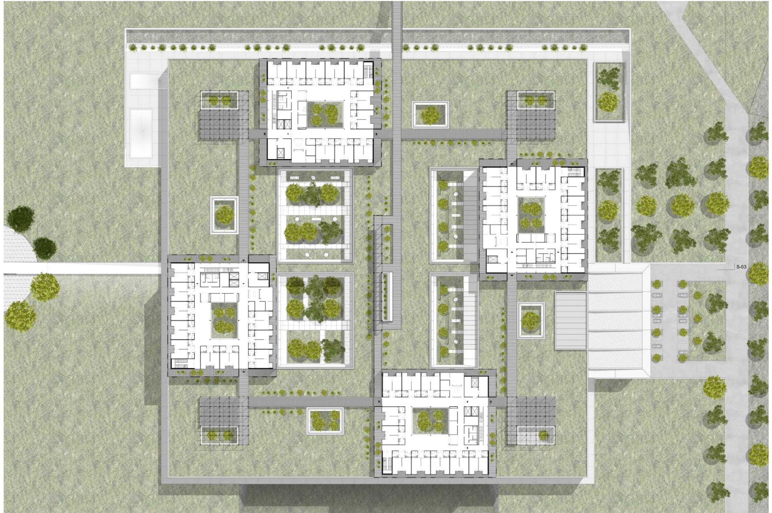
Abb. 47 Grundriss Bettengeschoß 1-3 M 1:1000
