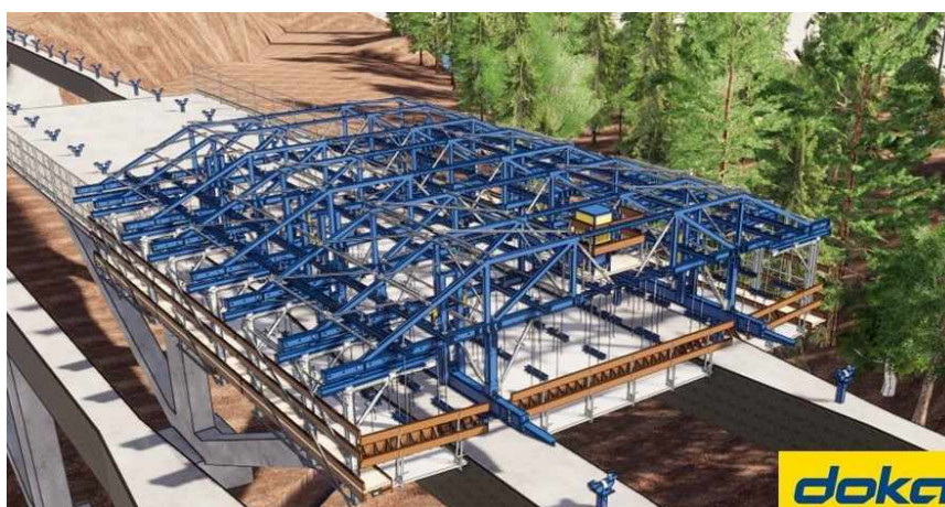
Abb. 7.1: 3D-Ansicht des Versetzwagens (Copyright: Doka GmbH )
