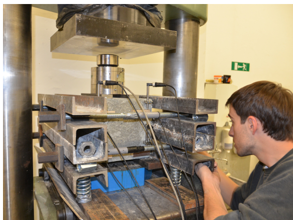
(b) Einrichten der Stahlträger
