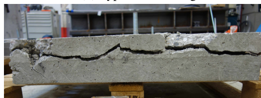
(d) Typ 2: seitlicher Riss
