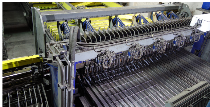
Abb. 4.3: Mattenschweißanlage der Firma Franz Oberndorfer GmbH & Co KG , Werk Herzogenburg
