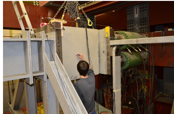
(a) Versuchskörper eingebaut in der Würfeldruckpresse (b) Versuchskörper eingebaut im Druckprüfrahmen
