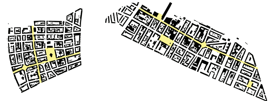
Abb. 68: Schwarzplan der Quartiere Matthäus (links) und Gundeldingen (rechts). Farblich hervorgehoben sind die Platzräume und die belebten, wichtigen Achsen.
