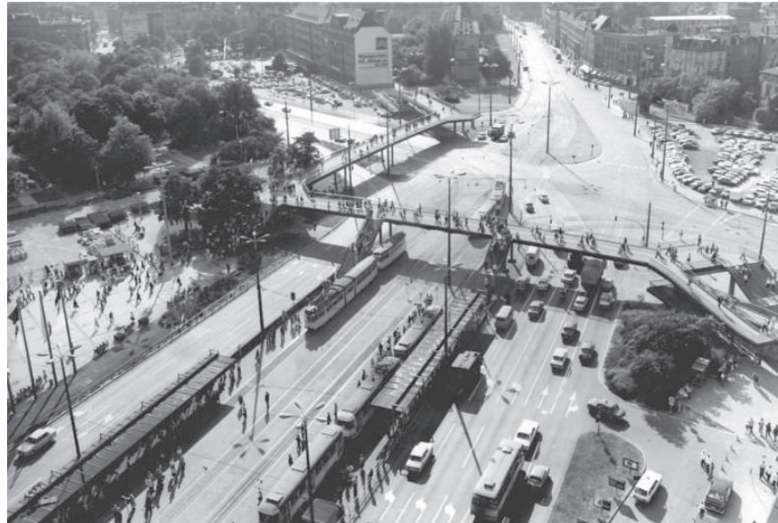
Abb. 32: Die autogerechte Stadt: Trennung der Verkehrsträger, Fußverkehr auf separater Ebene, mehrspurige Stadtautobahnen. Entdichtete Stadt. Leipzig, Friedrich Engels-Platz, Dt. Bundesarchiv.
