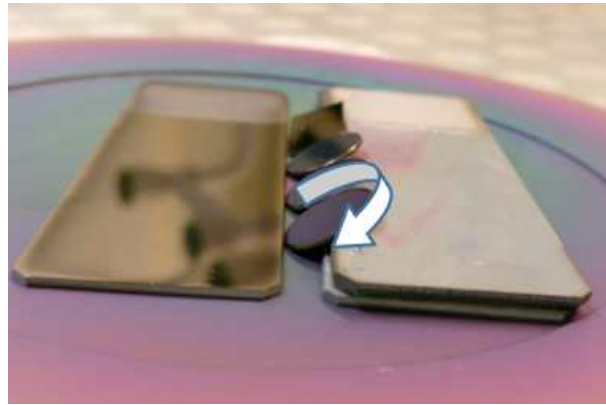
Abbildung 5.5: Substrat Präparation für das Abscheiden von AlN Schichten unter einem Abscheidewinkel von 30-40°. Zwischen den Abscheideprozessen werden die Substrate rotiert.
