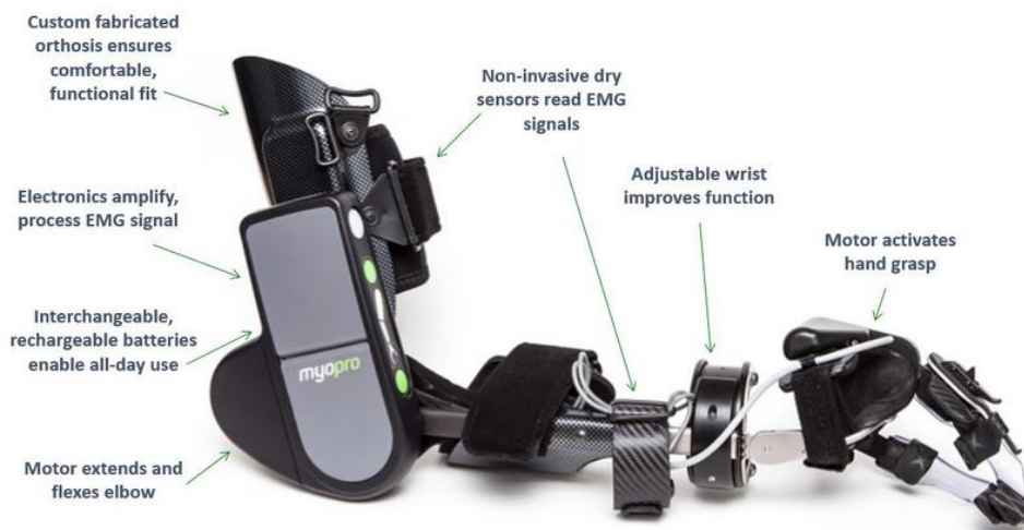
Abbildung 1-22: MyoPro Technische Details
