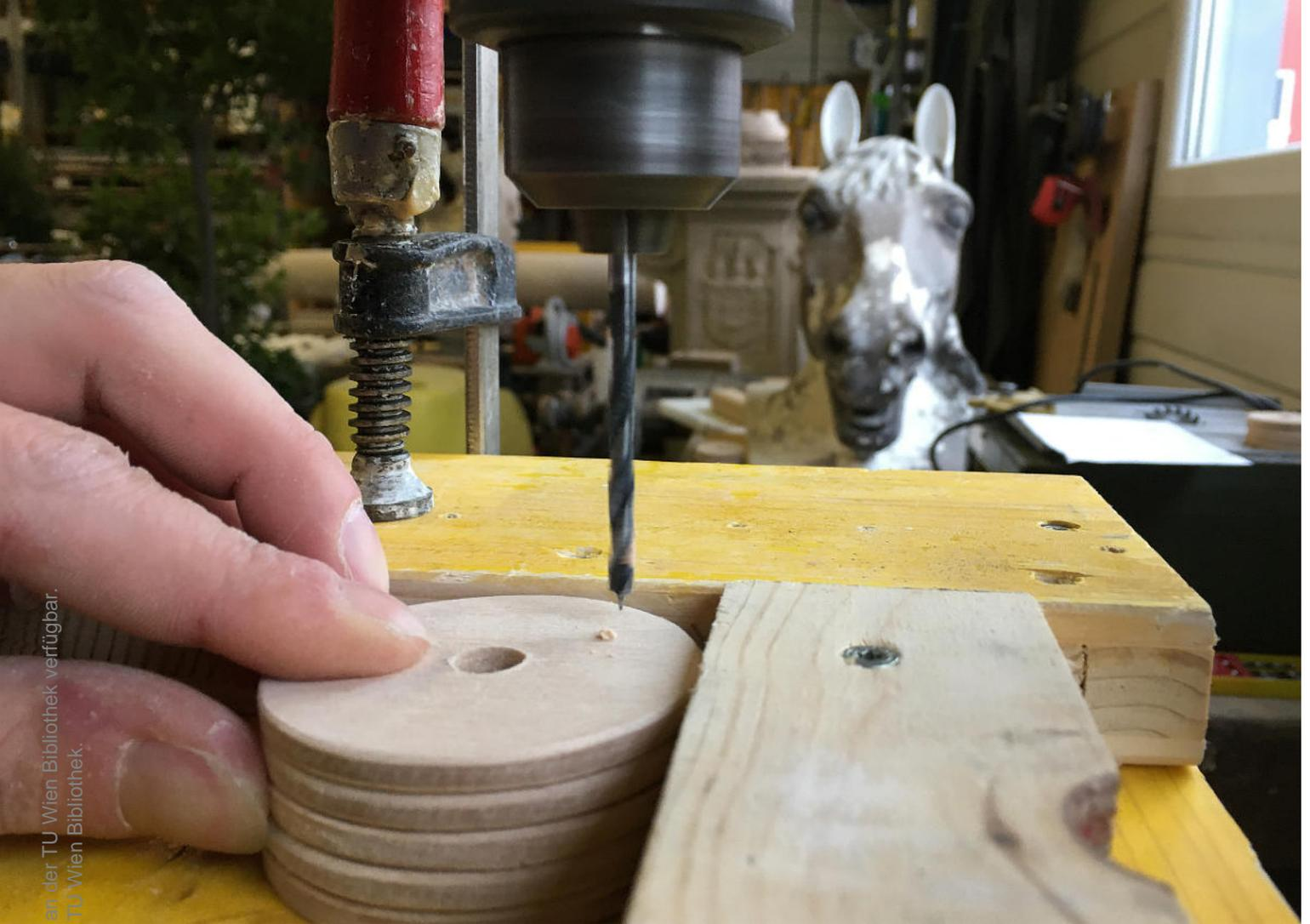
Abb. 123: Bohren der Löcher ↑
