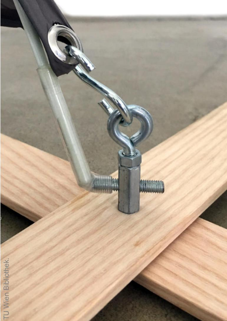
Abb. 116: GFK-Stab seitlich montiert ↑
