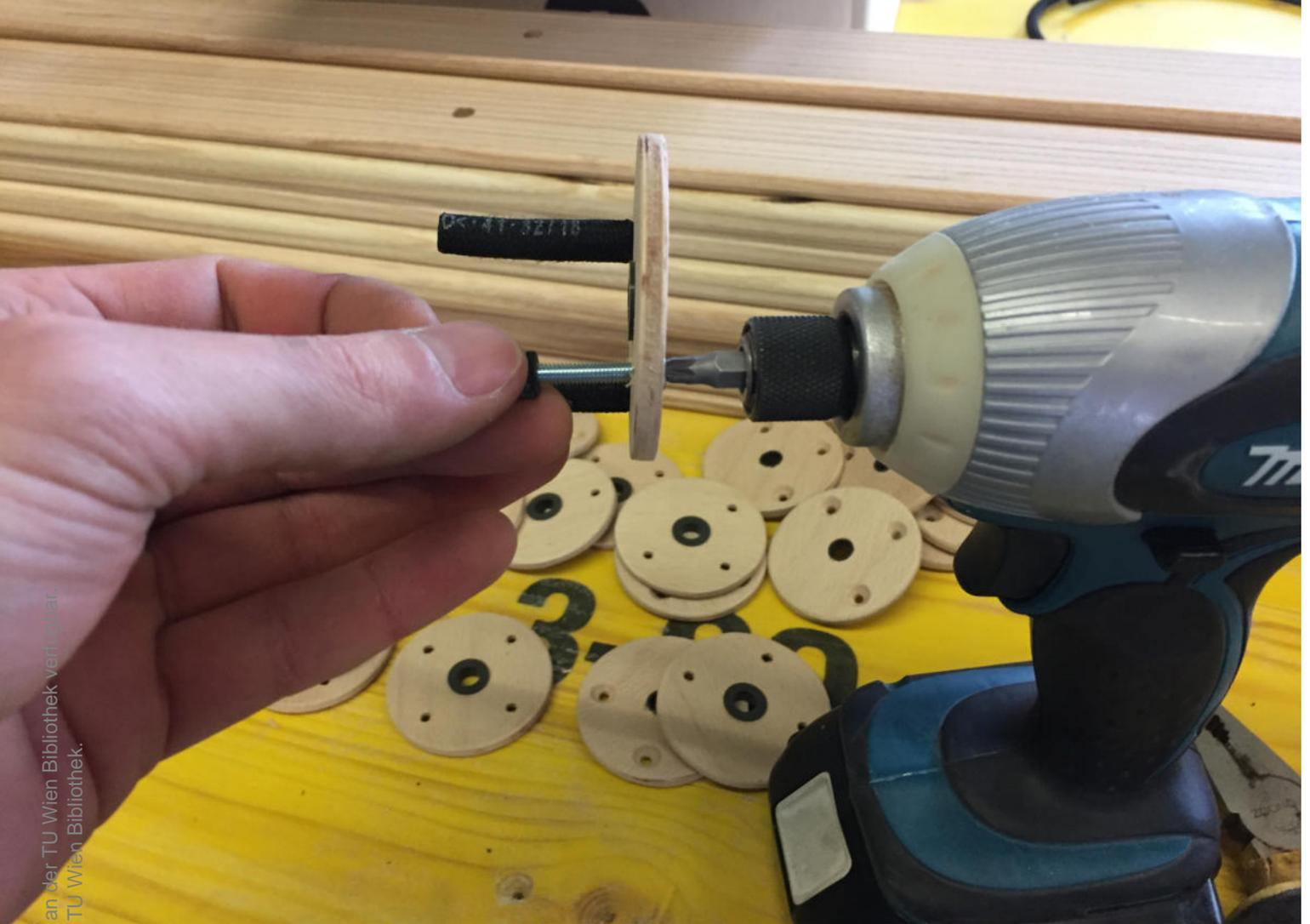
Abb. 131: Montieren der Schläuche-02 ↑
