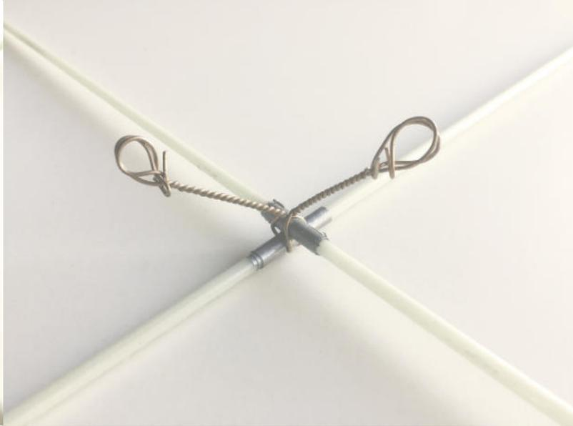
Abb. 135: Drahtverbindung der GFK-Stäbe
