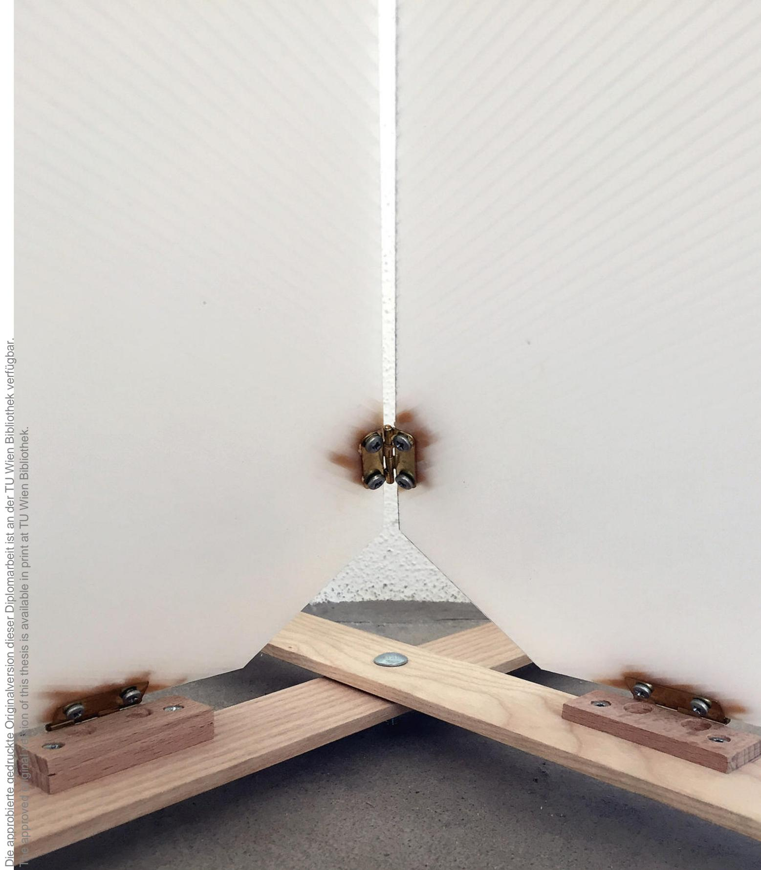
Abb. 74: Mechanismus mit PP-Stegplatte Montage
