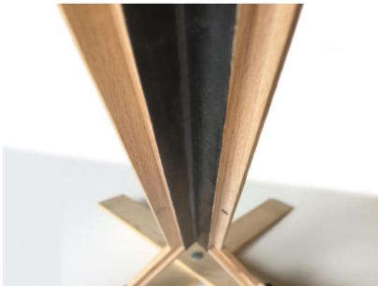
Abb. 56: Plane als Scharnier Montage
