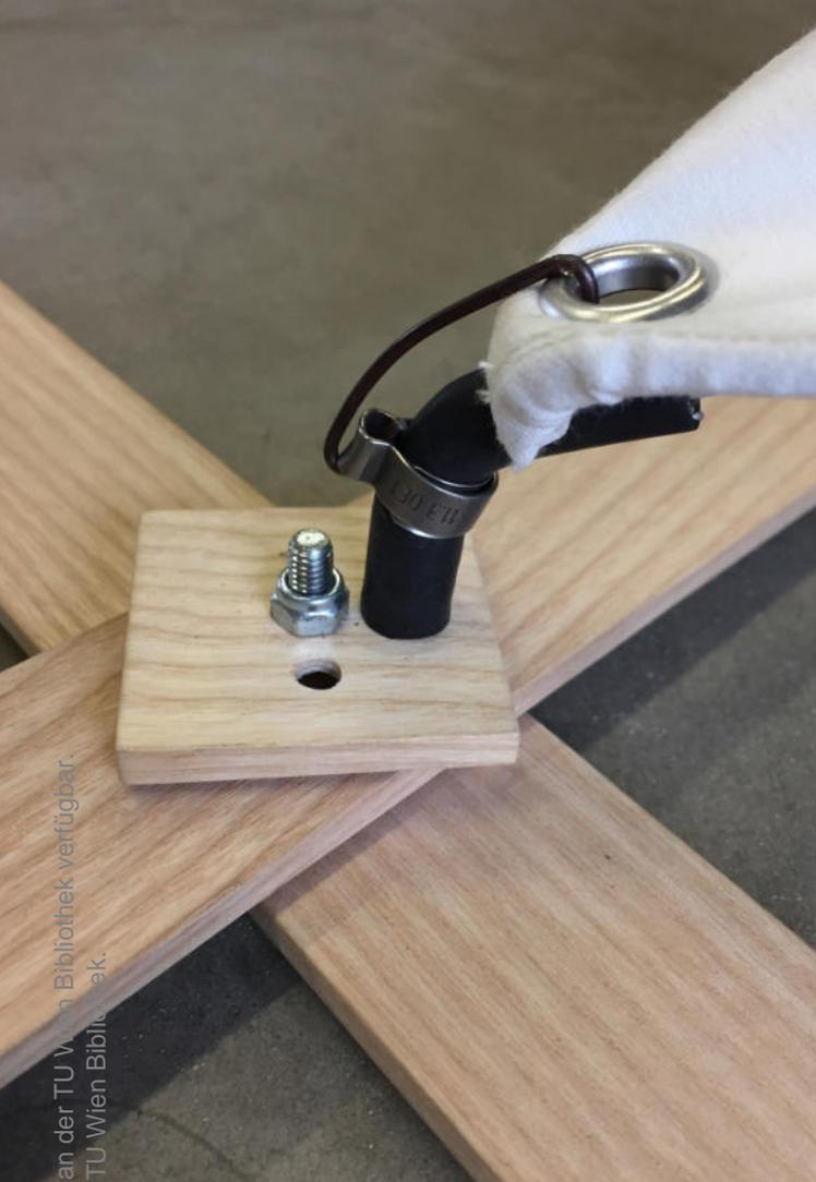
Abb. 113: Membran in Schelle eingehakt ↑
