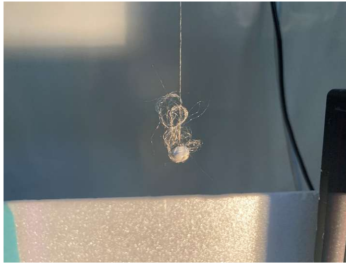
Abbildung 44 Steeltech Faden nach dem Bruch
