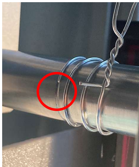
Abbildung 35 Bruch einer Aluminiumprobe direkt am oberen Wicklungszyylinder
