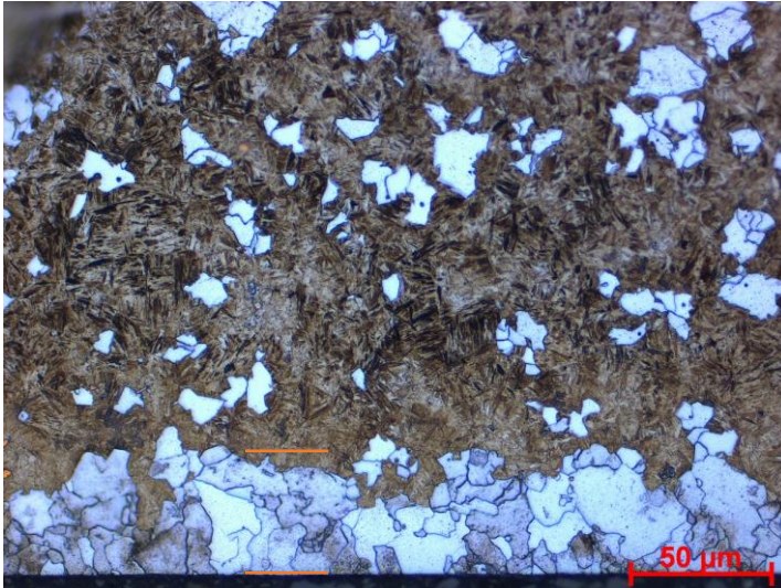
Abbildung 4.37: Gezeigt ist der Randbereich der mit Nital 2% (acht Sekunden Ätzdauer) geätzten Probe 2W3.
